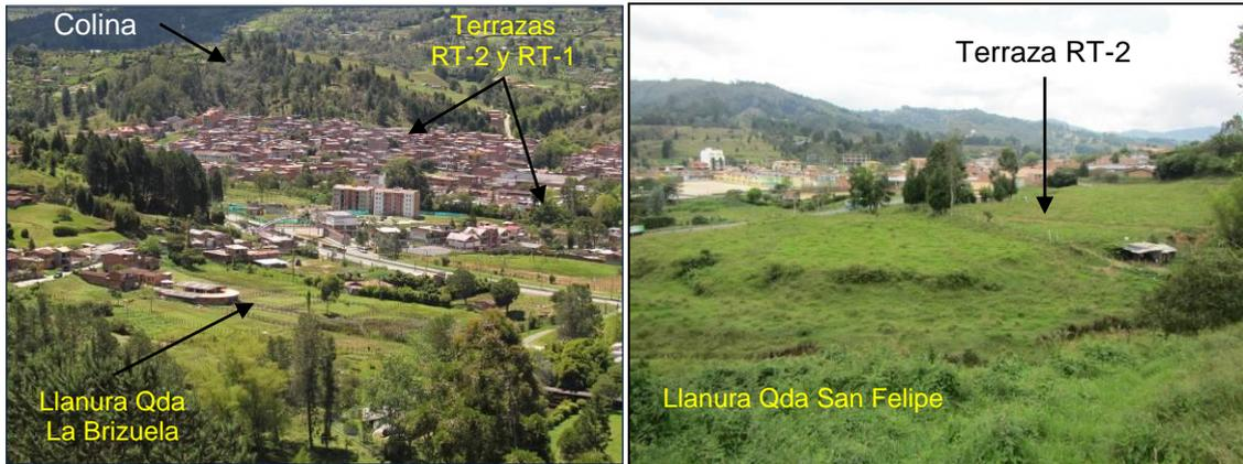
**Escarpe de Terraza.** Está unidad se conforma de franjas alargadas paralelas a los afluentes secundarios de la quebrada La Mosca que labran su cauce sobre los depósitos de las terrazas aluviales. Estos escarpes subverticales son producto de erosión hídrica laminar intensa sobre la superficie de las terrazas y carcavamiento remontante desde la desembocadura de los afluentes estacionales, hasta la parte media de las cuencas.
